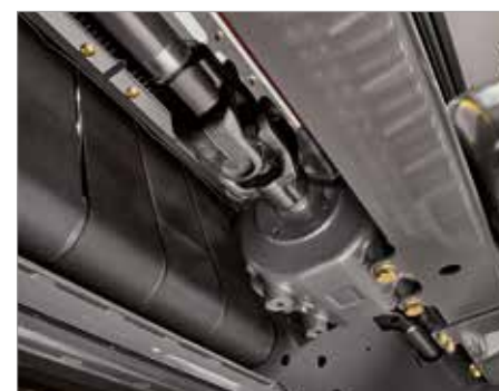
7. Поперечні шарніри ведучих осей, що витримують великі навантаження
