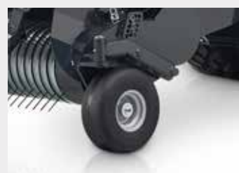
Поворотні напівпневматичні копіювальні колеса підбирача
