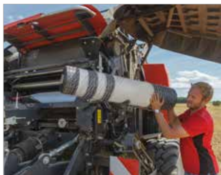
7. Кронштейни для кріплення рулонів сітки
