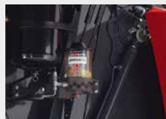
Автоматична система змащування
