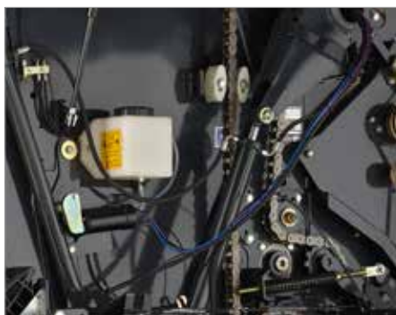
7. Автоматична система змащування ланцюгів
