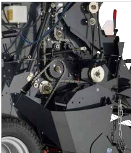
1. Надійний привід із високоякісними ланцюгами IWIS
