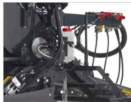
6. Система безперервного змащування ланцюга ВЕКА-МАХ
